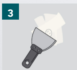
3 Encher o furo com massa de colagem para Drywall. Após secagem, se necessário, aplicar nova camada de massa de colagem.
